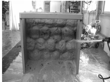
Lassan kötő anyaggal készült hátűrinjektálás
