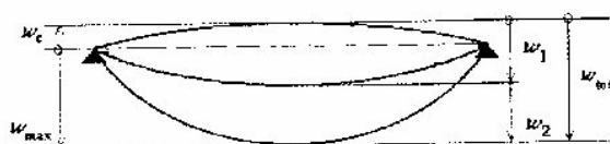
7.1. ábra: Függőleges lehajlások értelmezése
